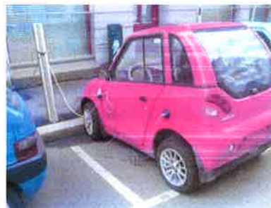
Fig 10 – Skjøteledning på ladekabel
