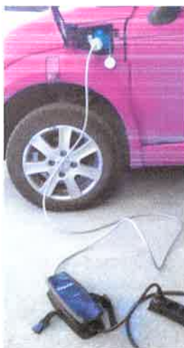
Fig 2 - Mode 2 - Vanlig kontakt - Schuko med ladeboks på ledning
